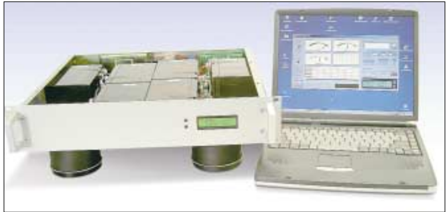
In einer 2000-VA-USV eingebaute BACS-C1-Module: Die Anpassung der Module an den Batterietyp kann per Notebook erfolgen. Später ersetzt ein BACS-Web-Manager das Notebook.
