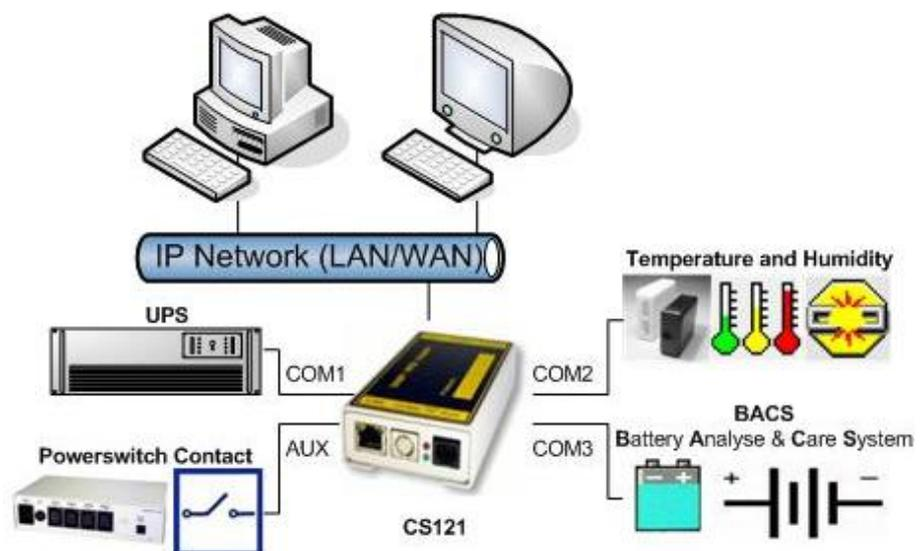
Le CS121 (non BUDGET) produit après 04/2007 est équipé d'un port AUX (com3) qui permet le raccordement du **BACS (Battery Analyse & Care System)**.
