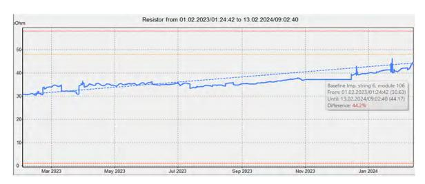
Bild: BACS VIEWER zeigt den Trend der Impedanz des Akkus No.106 für den Zeitraum von 1 Jahr als gestrichelte blaue Linie an. Die Infobox dazu zeigt eine Differenz von 44.2% in "rot" an und signalisiert damit das dieser Akku sich erheblich verschlechtert hat in dieser Zeit. Hier besteht für den Batterieservice Handlungsbedarf in spätestens 2 Monaten wird die Warnschwelle "orange" erreicht und vermutlich kurz darauf auch die Alarmschwelle "rot".
