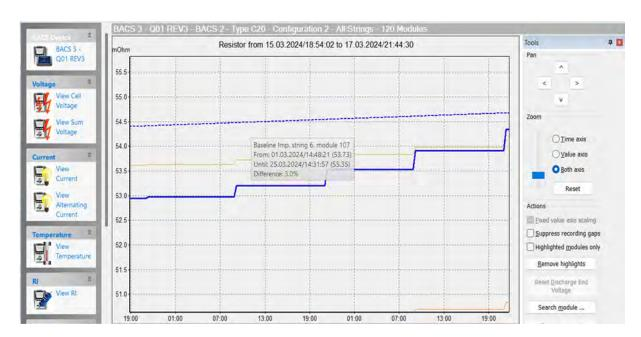
Bild: BACS VIEWER zeigt mit der gestrichelten Linie den Trend für die ansteigenden Impedanz von Akku Nr. 107 an. Innerhalb von weniger als 1 Monat hat der Akku eine um 3% höhere Impedanz. Dieser Anstieg ist deutlich schneller als alle anderen Akkus im Strang – hier gelbe Linie - und bei dem absoluten Wert von über 50mOhm ein eindeutiger Hinweis auf das erreichte "Lebensende" dieses Akkus.
