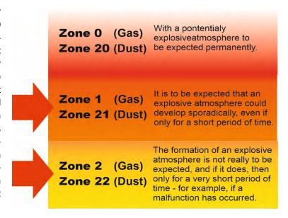
Bild: Die Grafik zeigt die unterschiedlichen ATEX – Zonen. BACS ATEX ist für die Schutzzonen 1/21 für Gase bzw. 2/22 für Staubumgebungen ausgelegt.
