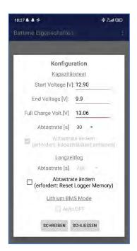
Bei Erreichen der eingestellten Grenzwerte wird der SMARTLOGGER / SMARTBATTERY die Aufzeichnungsfrequenz erhöhen und die Entladungsaufzeichnung beginnt. Nach Ende der Entladung errechnet die APP die entnommene Kapazität in Ah von Beginn bis zum Ende der Entladung.
