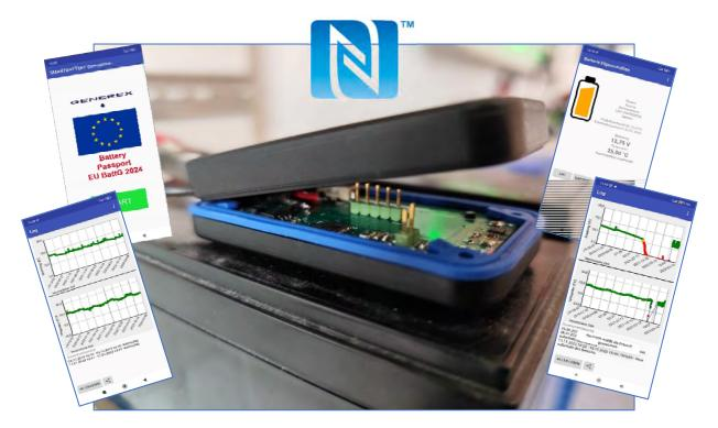
Bild: Der SMARTLOGGER geöffnet mit Anschluss für externe NFC-Antenne - liefert als vollwertiges Offline-BMS per NFC ein umfassendes Bild über den Einsatz der Batterie seit Produktionsdatum bzw. Kommissionierung und erfüllt damit sowohl die Vorgaben des EU BattG 2024 als auch die des DSGVO (Datenschutz). Alles, was Sie benötigen, ist die SMARTLOGGER Companion App, welche kostenfrei im Google Play Store zum Download verfügbar ist.
