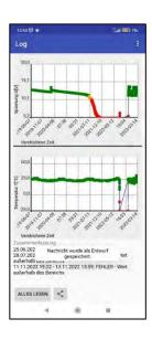
Da die SMART-Technologie ein Bestandteil der Batterie ist, speichert der SMARTLOGGER ununterbrochen Betriebsdaten zu der jeweiligen Batterie und liefert via NFC alle notwendigen Daten, um eine Aussage über den Handlungsbedarf treffen zu können. Die Speicherkapazität beträgt bis zu 10 Jahre.
