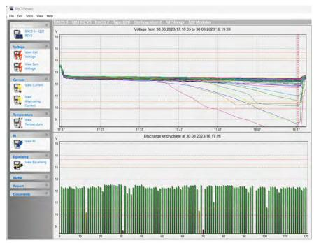
Picture: BACS VIEWER zeigt die "Entladung 1" von allen 120 Akkus bei gleichbleibender Last über die Dauer von 1 Stunde. Das Ende der Entladung stellt die vertikale rote gestrichelte Linie dar. Diese Entladung muss einfach mit einer ähnlichen Entladung vor 1 Jahr oder früher verglichen werden, um den Kapazitätsverlust und Verursacher zu ermitteln.
