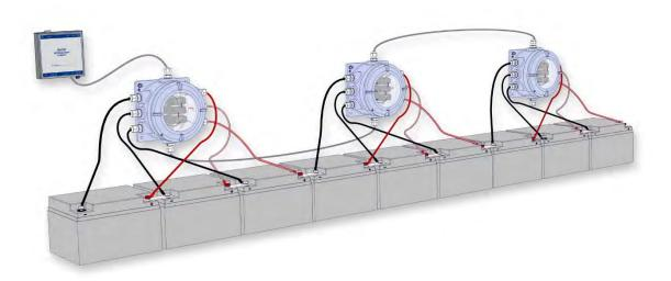
Bild: Die Grafik zeigt den Aufbau der ATEX-Version von BACS – Die Module befinden sich in den ATEX – zertifizierten Gehäusen auf einer speziellen Trägerplatine – der BACS-Webmanager könnte bei Bedarf zudem in einen ATEX- konformen CC-Schrank untergebracht werden.
