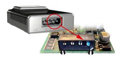
Unsere Untersuchungen haben ergeben, dass die BACS-Module (und auch alle Anschlusskabel) mit einem basischen Elektrolyten kontaminiert waren.
