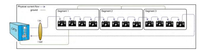
Funktionsprinzip eines Differenzstromsensors:
