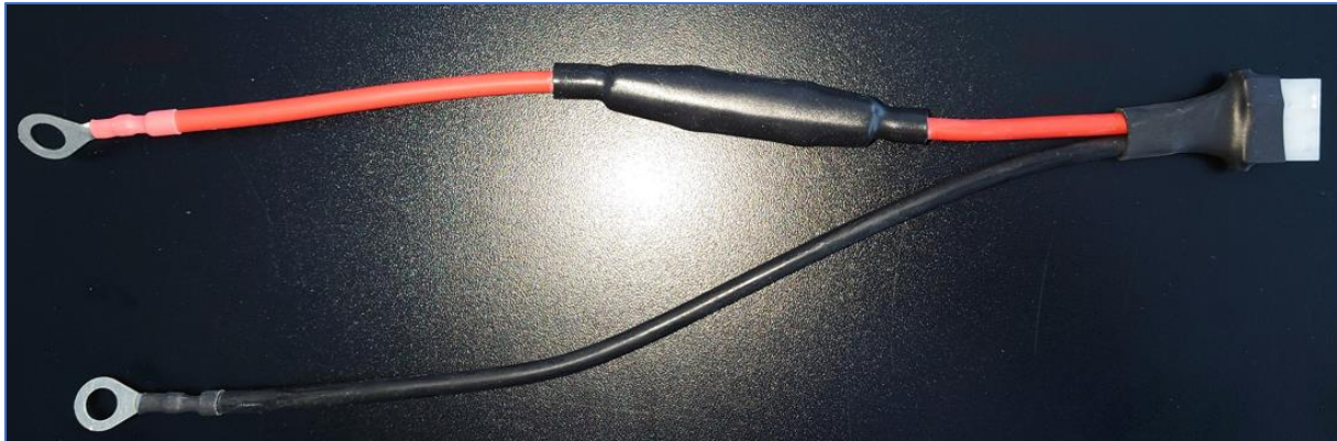
Das Bild zeigt ein typisches halogenfreies BACS BC5 Messkabel. Deutlich zu erkennen ist die gasdichte Versiegelung der 1000V Schmelzsicherung. Durch die gasdichte Versiegelung wird verhindert, dass beim Ladeprozess ausdünstender Wasserstoff entzündet werden kann.
