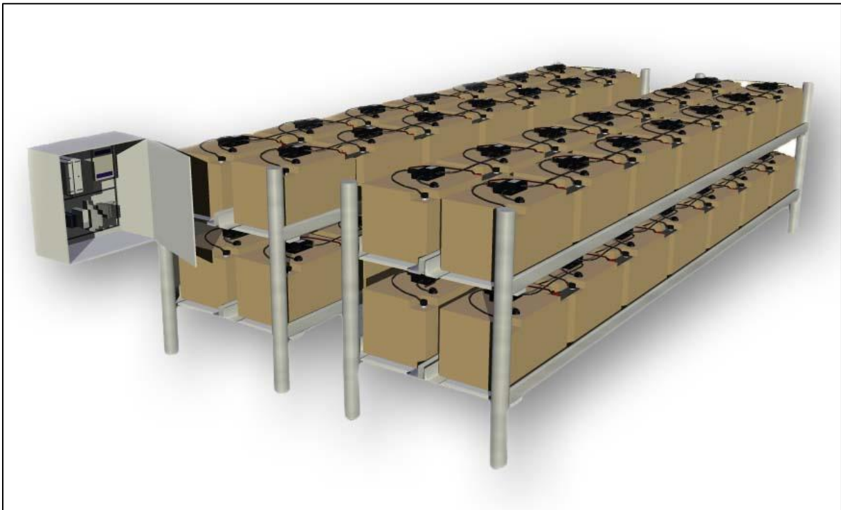
Abbildung: Typischer Aufbau eines BACS-Systems
