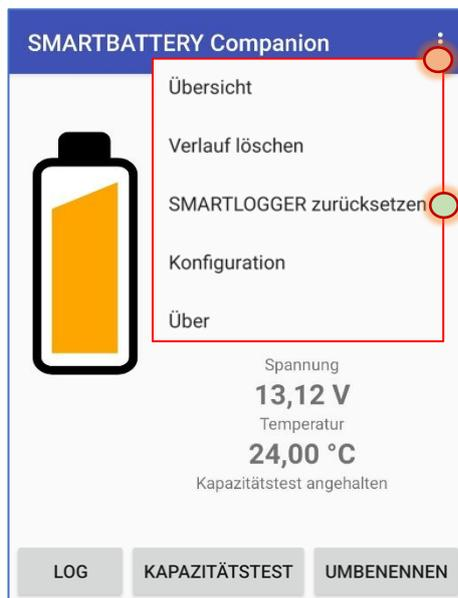
Diese Funktion ist nur für den SMARTLOGGER verfügbar. Beim Reset wird der jeweilige SMARTLOGGER auf Auslieferungszustand zurückgesetzt, wobei alle zuvor getätigten Einstellungen und erhobenen Daten gelöscht werden.
