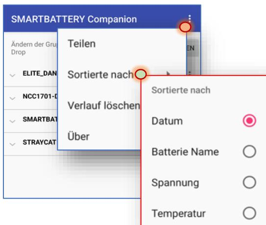
Sie können über unterschiedliche Sortier- und Filterfunktionen die erhobenen Batterien innerhalb einer Gruppe neu anordnen. Dabei ändert sich die Reihenfolge der Batterien innerhalb einer Gruppe - Die Batterien werden nicht in anderen Gruppen verschoben.
