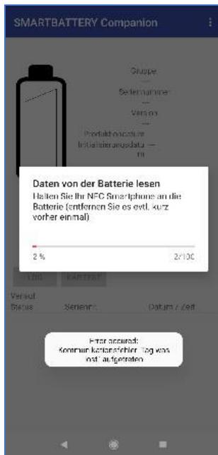
Unter bestimmten Bedingungen kann es passieren, dass über NFC die Daten nicht korrekt überspielt werden. Das geschieht z.B., wenn die Geräte zu weit auseinander sind, zu früh zum nächsten SMARTLOGGER gewechselt wird oder das Mobilgerät zu sehr bewegt wird. Die Companion App weist mit einem Hinweisfehler und einem Fehlerton darauf hin, dass die Batterie nicht korrekt oder vollständig ausgelesen werden konnte:
