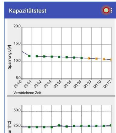
Der berechnete Wert gibt einen Überblick, ob eine Batterie innerhalb der gesetzten Parameter korrekt funktioniert. Wenn der berechnete Wert ungewöhnliche Ergebnisse bringt, sollte die Batterie auf jeden Fall genauer überprüft werden – die statische Komponente, die für den Test und die Berechnung notwendig ist, wird über den Verbraucher abgebildet, dessen Leistung bekannt ist.
