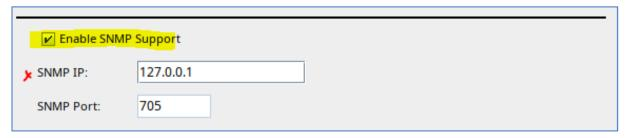
Aktivieren Sie im UPSMAN Configurator jetzt unter System den SNMP support. Da Sie auf dem Rechner SNMPD konfiguriert haben, der auch die UPSMAN-Installation enthält, soll der UPSMAN sich intern über die IP-Adresse 127.0.0.1 auf Port 705 verbinden.
