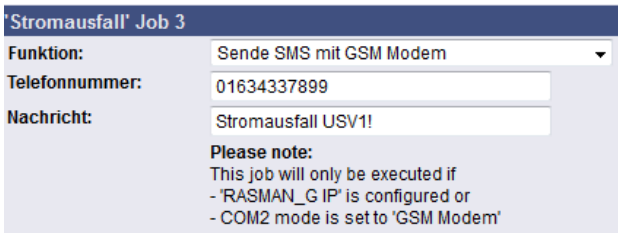
Abbildung 117: Konfiguration der Funktion „Send SMS with GSM modem“
