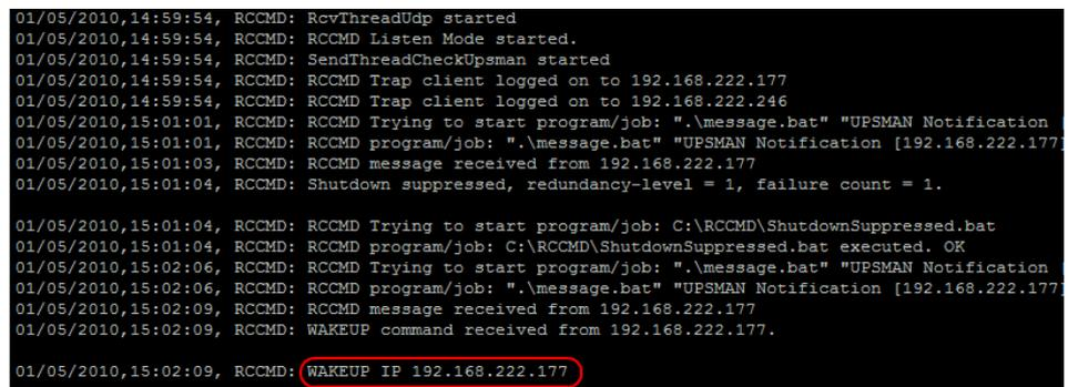
Fig. 113: „WAKEUP“ Befehl im RCCMD Log
