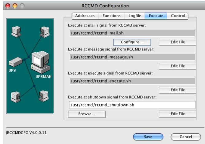
Fig. 179: RCCMD Configuration Window „Execute“
