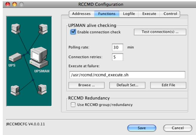
Fig. 175: RCCMD Configuration Window „Functions“
