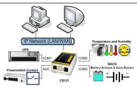
2007년 하반기 이후 출시되는 CS121(B모델 제외)는 AUX(COM3) 포트에 BACS 배터리 관리 시스템을 연결 가능하도록 설계됩니다.
